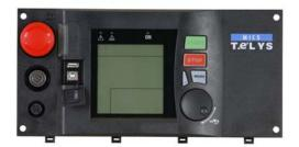
NEXYS – это многофункциональное устройство управления, обеспечивающее функционирование ДГУ как в ручном, так и в автоматическом режиме. Оснащенный ЖК дисплеем, дружественный по отношению к пользователю, NEXYS предоставляет пользователю основной набор функций для обеспечения простой и надежной работы Вашей генераторной установки.
