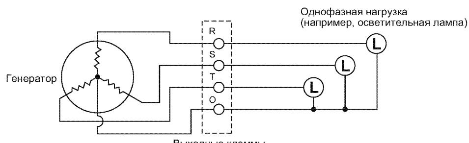
Нагружайте выход генератора так, чтобы каждая фаза была сбалансирована. Если нагрузка не сбалансирована, выдерживайте разность фаз в пределах 20%.
