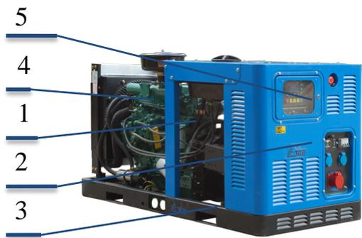
**1)Дизельный двигатель** в сборе, оборудован системами обеспечения; с непосредственным впрыском топлива, водовоздушным охлаждением и регулятором частоты вращения;
