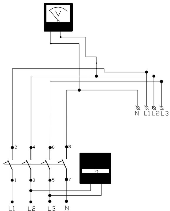
Рис. 5а. Электрическая схема силовая электрогенератора с двигателем Lombardini LDW1603
