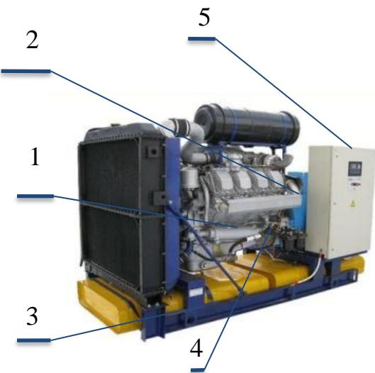
**1)Дизельный двигатель** в сборе, оборудован системами обеспечения; с непосредственным впрыском топлива, водовоздушным охлаждением и регулятором частоты вращения;
