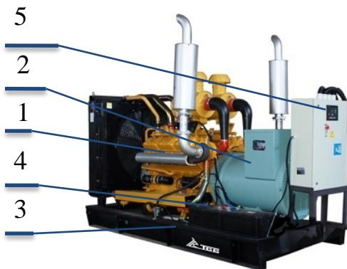
**1)Дизельный двигатель** с непосредственным впрыском топлива и водовоздушным охлаждением, с турбокомпрессором и регулятором частоты вращения; Установленным навесным оборудованием и оборудован системами обеспечения.
