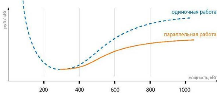
Создания схемы двойного резервирования при помощи 2-х и более генераторов аналогичной мощности увеличивает вероятность удачного запуска генератора, в случаях, когда недопустим перерыв в электропитании потребителей. гарантированный запуск даже при не запуске одной из электростанций, для электропитания ответственных потребителей, когда неудачный запуск генераторов приводит к серьезным последствиям.
