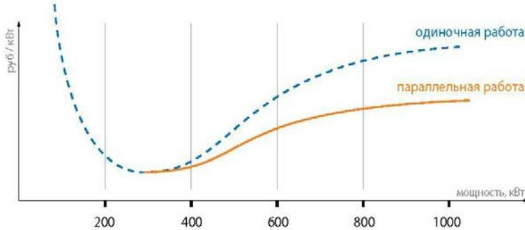
Создания схемы двойного резервирования при помощи 2-х и более генераторов аналогичной мощности увеличивает вероятность удачного запуска генератора, в случаях, когда недопустим перерыв в электропитании потребителей. гарантированный запуск даже при не запуске одной из электростанций, для электропитания ответственных потребителей, когда неудачный запуск генераторов приводит к серьезным последствиям.
